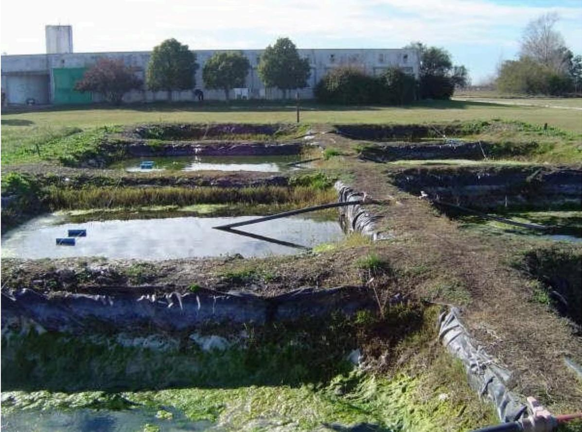
En la primer imagen, el color verde opaco muestra un ambiente acuático muy eutrofizado y con cianobacterias en el embalse de Salto Grande (Río Uruguay). En la segunda, piletones en los que se ensayaron diferentes concentraciones de glifosato en el agua para analizar el rol del herbicida en el proceso de eutrofización (Instituto Tecnológico de Chascomús).
